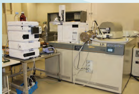
二重収束質量分析計 JMS-700MStation (日本電子) 平成 21 (2009) 年度導入 研究設備共用センター 1階 質量分析室
