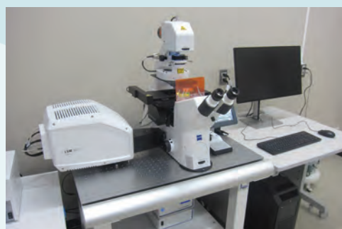
共焦点レーザー顕微鏡 LSM900 with AiryScan2 (カルツァイス) 令和6 (2024) 年度導入 研究設備共用センター 1階 質量分析室
